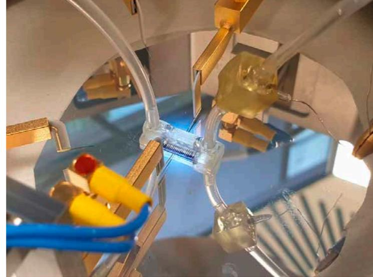
Graphen-Sensor für die ultrasensitive Lab-on-a-Chip- und Point-of-Care-Technologie mit einem mikrofluidischen Aufbau in einer Mikroprobe-Station.
